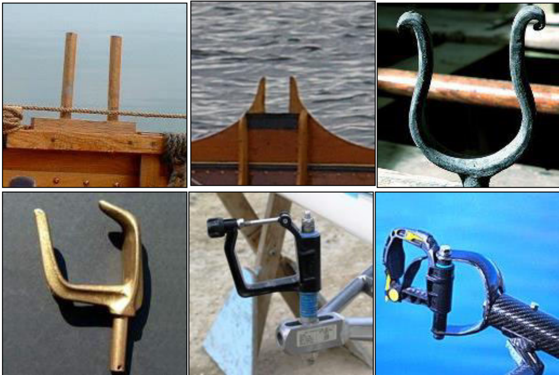
De ontwikkeling van de dol: van pennen, via scheehout naar de draaidol en moderne MK1 dol
